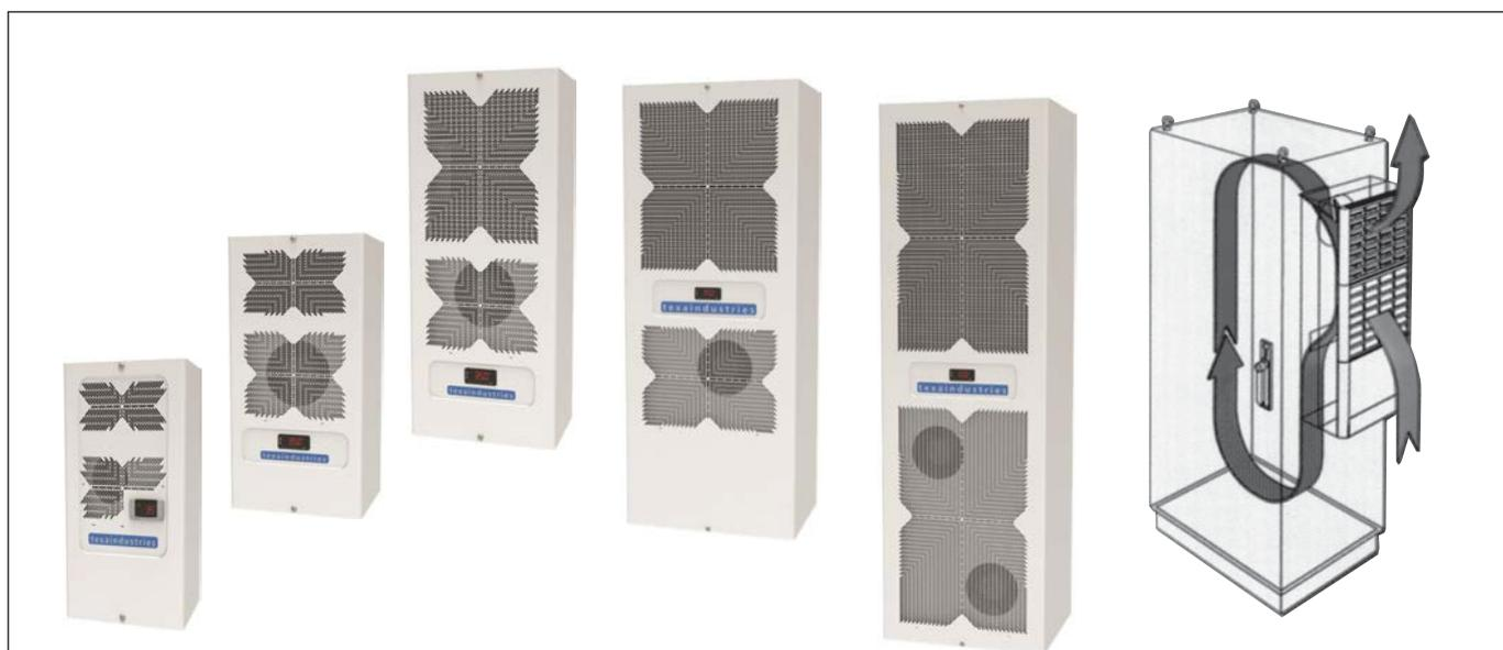
El aire caliente del interior del armario cede su elevada temperatura al entrar por la parte superior interna del refrigerador y retorna frío por la parte inferior interna del refrigerador. En la parte exterior ocurre lo contrario, el aire exterior entra en el refrigerador por su parte exterior inferior y es devuelto al ambiente por la parte superior externa habiendo absorbido la temperatura excesiva cedida por la bomba de calor.
