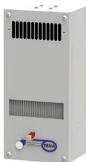
El funcionamiento de un intercambiador de calor se basa en el principio de la transmisión térmica entre dos superficies metálicas que estén a diferente temperatura. Gracias a los dos conductos de aire separados que tiene el intercambiador se iguala la temperatura del interior del armario con la exterior.
