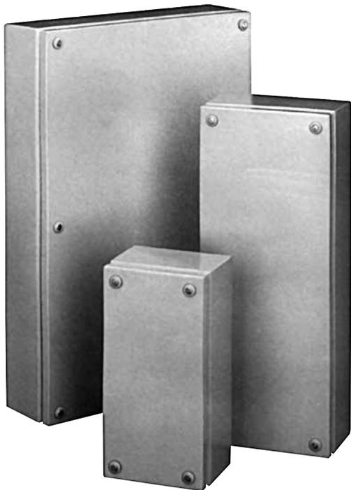
Cajas metálicas de acero de 1,2 mm. de grueso, monobloc, pintadas con poliéster color RAL 7032 especiales para el montaje de bornes, con railes perforados y soldados en el fondo de la caja, apropiados para el montaje de placas o perfiles DIN 35.
