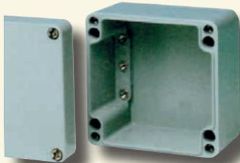
Cajas de bornes o pequeños montajes electrónicos, ejecución IP66. Construidas en poliéster más fibra de vidrio, en tamaños desde 75x80x55 hasta 400x405x120 (13 tamaños) color RAL 7000.
