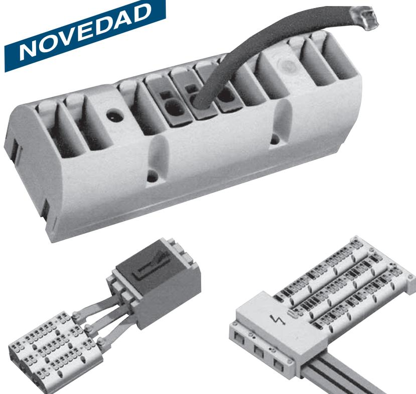
Bornes unipolares multifilares hasta 250 A, 690V para montaje directo sobre embarrados de cobre de hasta 30 x 5 ó en el Sistema 60. El conexionado de las salidas se efectua de acuerdo con las necesidades de la instalación entre 1 y 10 puntos de conexión de entre 1,5 a 10 mm<sup>2</sup> de sección del cable. Los conectores son enchufables a presión y la conexión de los cables es a presión sin necesidad de herramientas Sistema "Push-In".
