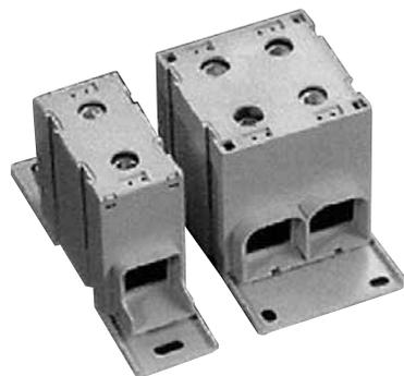
Bornes especiales bimetálicos para trabajar hasta 1000 V c.a. ó 1500 V cc. Intensidad de paso hasta 800 Amp. en cables de cobre y 630 Amp. en cables de aluminio, puede fijarse sobre perfil DIN de 35 mm o bien mediante tornillos en superficies, admiten cables o pletinas flexibles.
