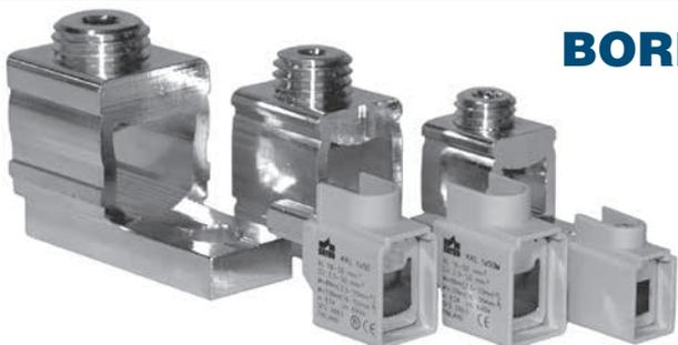
Bornes con o sin aislamiento IP00 bimetálicos para el conexionado de cables sin necesidad de terminales en las salidas o entradas de interruptores, disyuntores, etc. Suministrables para 1,5 a 240 mm<sup>2</sup> para conductores de cobre o aluminio de acuerdo con VDE0220 part 1/11,71 y 2/11, 71.
